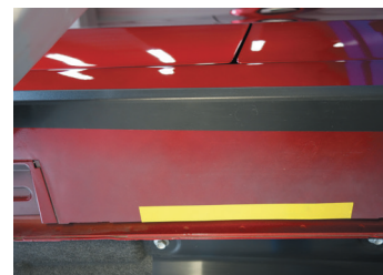
ジャッキ設置範囲 (テープ)
