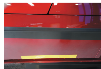
ジャッキ設置範囲 (テープ)
